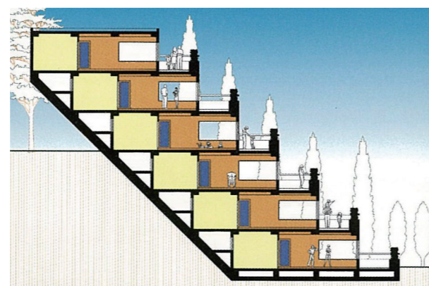
H2システムのプロトタイプによるユニテ宮崎(左/2000年竣工)。斜面地住宅は立体的な雁行ととらえ、斜行を生かし基礎を斜めにし、地耐力ではなく地盤との摩擦によって持たせるという考え方で、従来の階段状の基礎よりも土木工事の低減・コストダウンを実現した環境を壊さない独特の工法。広いルーフトラスが魅力で、戸建感覚で各戸に優れた採光性と眺望をもたらすプランとなっている
